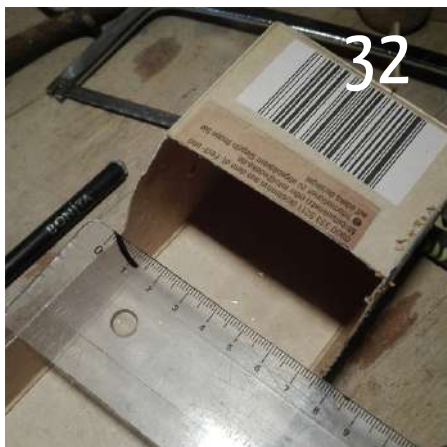
Das Maß für den Wickelmotor ist etwas kleiner, als die Breite des Maschinenraums (-0,5 cm).
