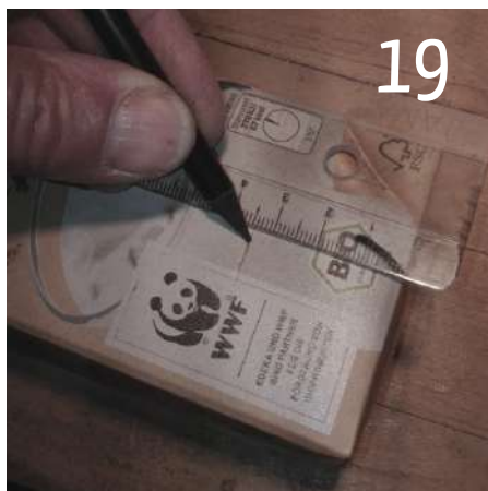
Anschließend werden die Löcher für die Achsen der Schaufelräder Backbord und Steuerbord vermessen:
