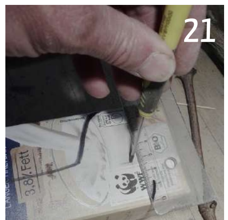
Die Löcher werden jetzt mit dem Schraubenzieher durchgestochen. Der Schraubenzieher sollte nur etwas dicker als der Zahnstocher sein:
