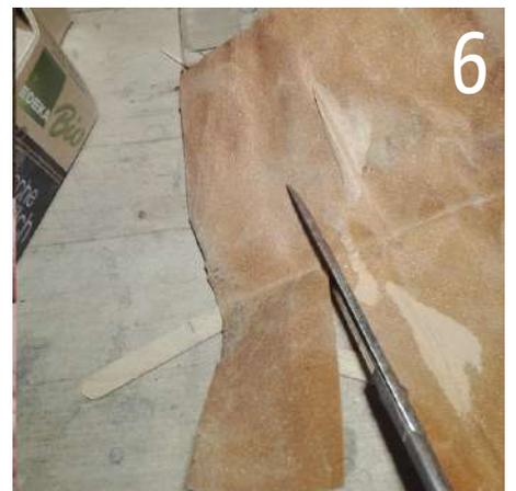
Schneide vom Schmirgelpapier einen Streifen in der Länge deines Sägeblattes ab.
