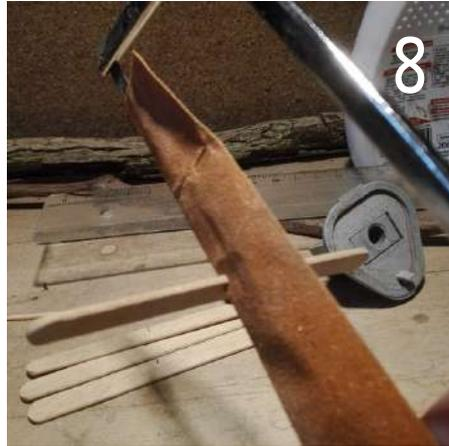
...und vergrößere den Schnitt in den Eisstielen genau auf die Dicke eines Stiels.
